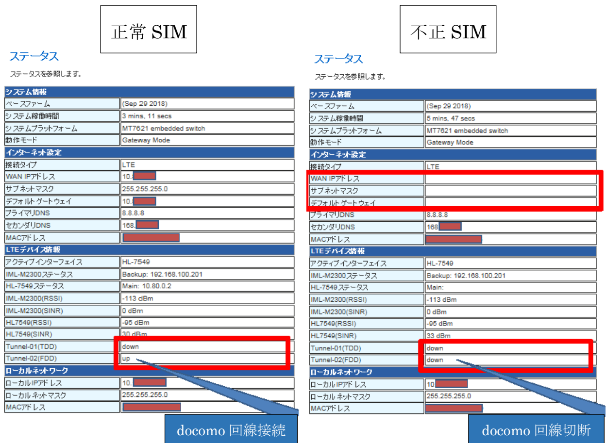
図 3.8 不正 SIM 挿入時の回線接続動作 (平成 30 年 11 月 22 日、長野県警察軽井沢警察署内機械室にて試験実施)
