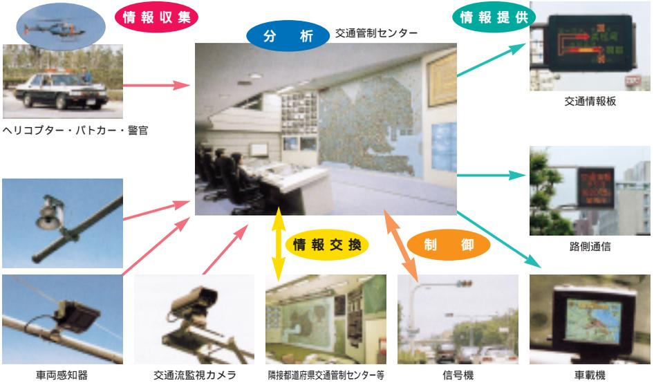
交通管制センターのシステム構成図
