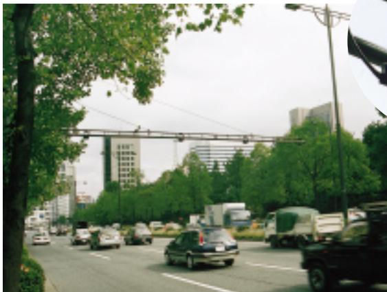
光ビーコンは、赤外線を用いた車載装置との双方向通信のほか赤外線投受光器から赤外線を路面に向けて発射し、車両からの反射波と路面からの反射波を比較して、車両の存在を感知します。
